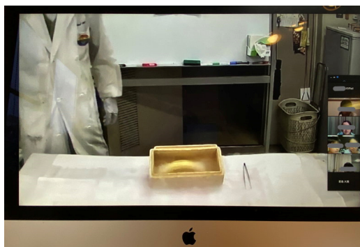
図6. 液体窒素中で固まったバナナ。この後、バナナを取り出して金槌代わりに用いる
