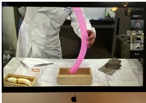
図8. バルーンアート用ゴム風船を液体窒素につけると萎み、さらに内部に液体が凝縮
