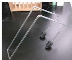
図1. 今回制作したガラス製U字管
