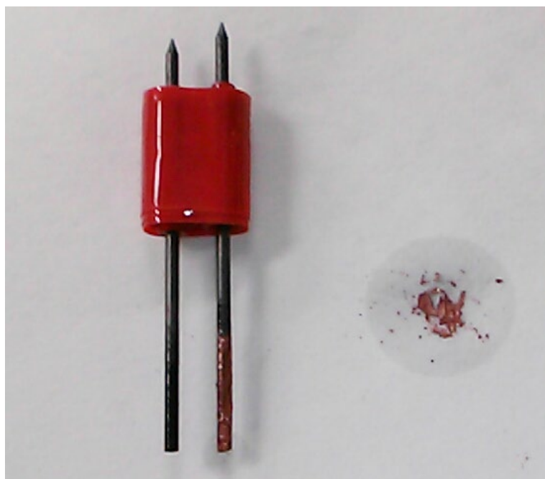
Figure 4 陰極（右）に析出した銅（一部、濾紙上に削り取った）
